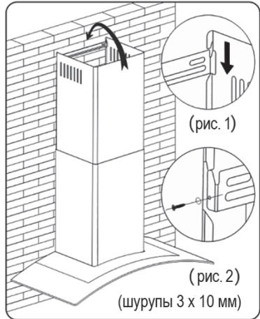
Произведите разметку, просверлите отверстия и закрепите два кронштейна для установки декоративных кожухов воздуховода. (Рис.12)
