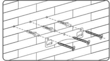
Просверлите три отверстия 8 мм для крепления кронштейна. Закрепите кронштейн на стене с помощью винтов и пластиковых дюбелей, входящих в комплект поставки. (Рис.9)
