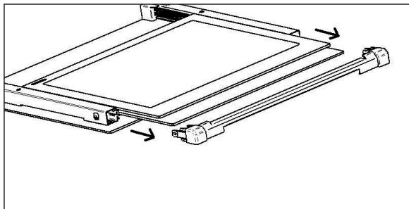
**ВНИМАНИЕ: ОБЯЗАТЕЛЬНО ЗАБЛОКИРУЙТЕ ПЕТЛИ (СМ СНЯТИЕ/УСТАНОВКА ДВЕРИ ДУХОВОГО ШКАФА) ПЕРЕД НАЧАЛОМ ИЗВЛЕЧЕНИЯ СТЕКОЛ ВО ИЗБЕЖАНИЕ СЛУЧАЙНОГО ЗАКРЫТИЯ ДВЕРИ И ПОВРЕЖДЕНИЯ СТЕКОЛ!**
