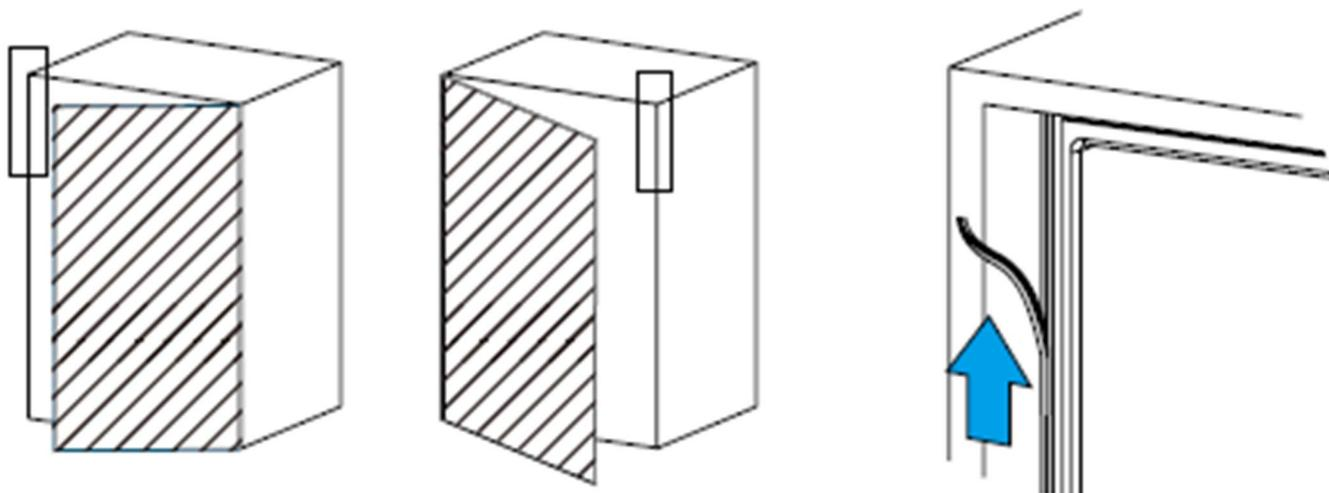
5. Установите элементы для фиксации холодильника, как указано на рисунке. Закрепите прибор в шкафу с помощью шурупов.
