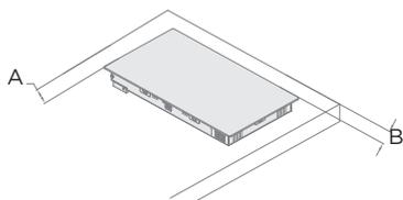
Варочную панель можно установить в виде плитки на столешницу на имеющиеся ножки. В таком случае расстояние до краев столешницы (А и В) должно быть не менее 50 мм.
