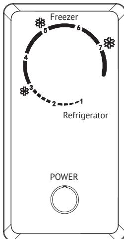
Температура внутри морозильной камеры регулируется ручкой терmostата.
