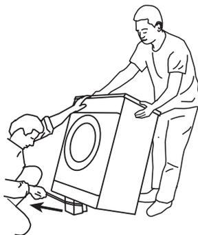
**СНЯТИЕ ТРАНСПОРТИРОВОЧНЫХ БОЛТОВ**
