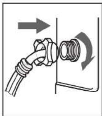
Если заливной шланг еще не установлен, вручную прикрутите заливной шланг к клапану на тыльной стороне стиральной машины.
