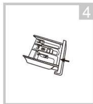
2. Приподнимите защелку, выньте отсек для кондиционера и промойте все пазы водой.
