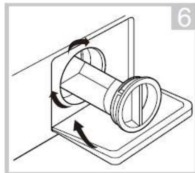
4. Медленно выкрутите фильтр, поворачивая в направлении против часовой стрелки.
