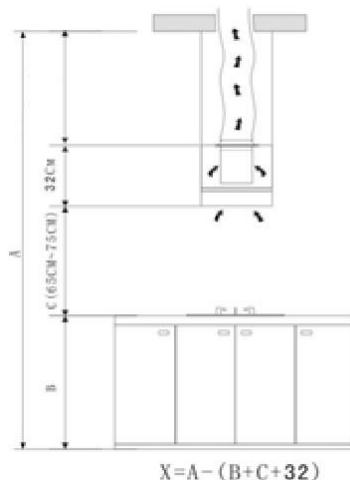
2. В целях обеспечения безопасности потолок должен выдерживать вес, равный не менее 120 кг, и иметь толщину более 30 мм.
