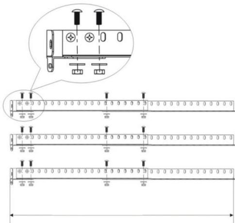
5. Закрепите угловые крепления на корпусе вытяжки и установите выдвижную трубу. См. рис. 3. Установите внутренний короб. а. Придерживая корпус вытяжки, затяните все саморезы и винты. См. рис. 4. Поднимите декоративный короб вытяжки и присоедините его к подвесной пластине.
