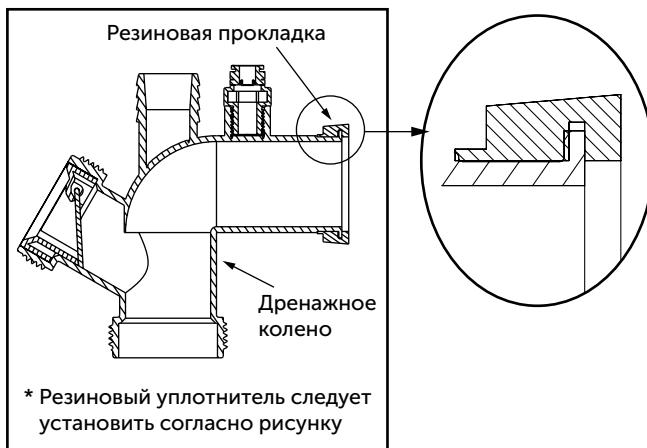
⚠ Примечание: внутренний паз резинового уплотнителя должен быть прижат к фланцу дренажного колена, как показано на рисунке выше.
