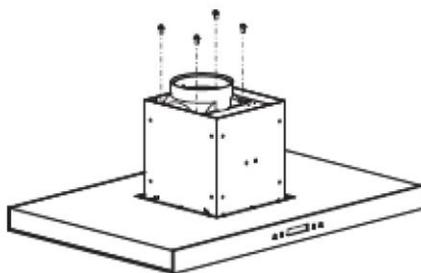
7. Поднимите вытяжку; используйте 16 больших винтов с плоской головкой (M4\*10) для соединения корпуса вытяжки и углового крепления.
